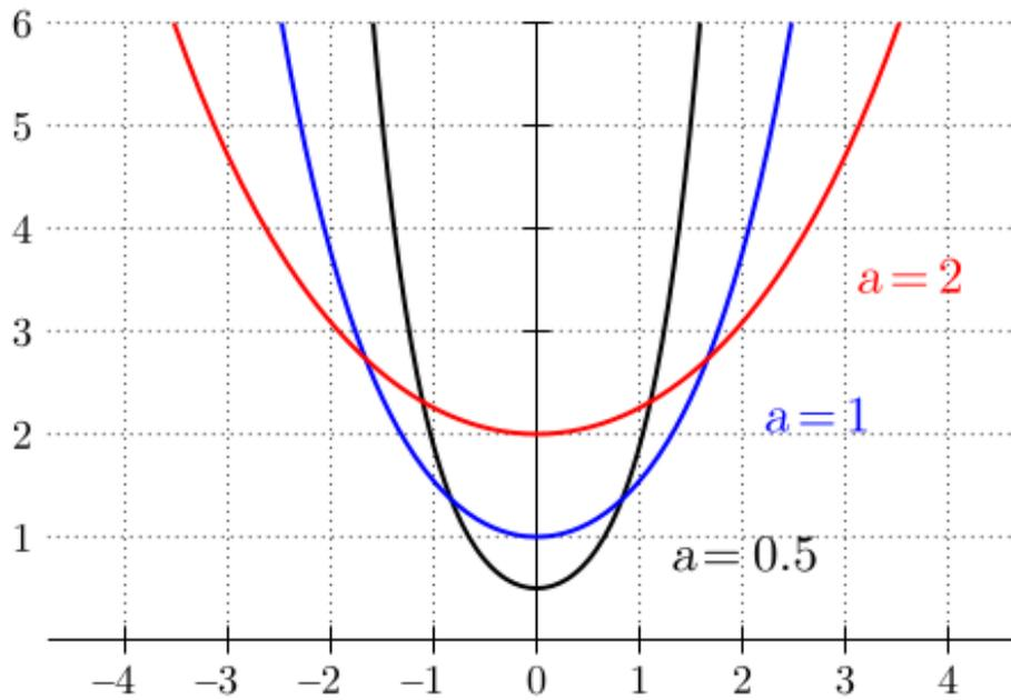
En el caso de cable suspendido de dos puntos a la misma altura, la longitud del arco, con el origen de arco en el mínimo es:
